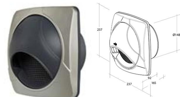
**Ablufthaube mit Fliegengitter und magnetischer Rückstauklappe, eckig, 150er System**
