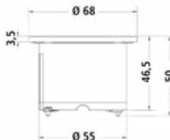
**Pix Steckdose, 1-fach, 2000mm Netz-Anschlussleitung, Montagestecker lose beiliegend, Bohrung ca. Ø 55mm**
