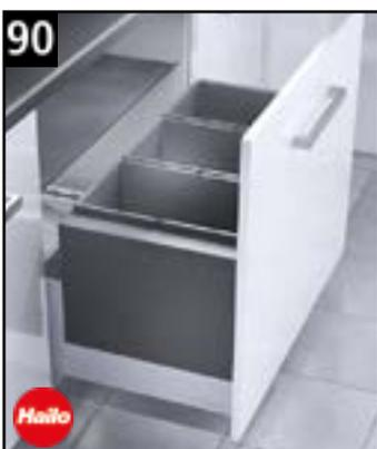
60 Schubkasteneinsatz für alle handelsüblichen Schubkästen. (Seitenwandstärken 16 bis 19 mm) System wird einfach auf Schubkasten aufgesteckt und mit wenigen Schrauben befestigt. Metall-Seitenteile der Triple XL-Box decken die Rellingstangen der Auszüge hygienisch ab. Mit Metallsystemdeckel. Schrankbreite: 600 mm Maße: T x H: 400 x 402 mm
