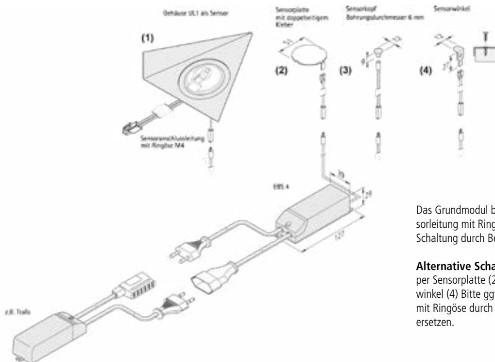
Das Grundmodul besteht aus Schalter und Sensorleitung mit Ringöse. Nach Installation erfolgt die Schaltung durch Berühren des Metallgehäuses (1)
