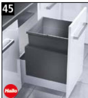
**45** Schubkasteneinsatz für alle handelsüblichen Schubkästen. (Seitenwandstärken 16 bis 19 mm) System wird einfach auf Schubkästen aufgesteckt und mit wenigen Schrauben befestigt. Metall-Seitenteile der Triple XL-Box decken die Rellingstangen der Auszüge hygienisch ab. Mit Metallsystemdeckel. Schrankbreite: 450 mm Maße: T x H: 400 x 522 mm
