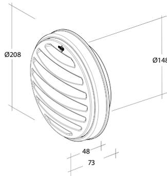
Lüftungsgitter Basic, mit Fliegengitter, rund, 150er System
