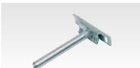
Tablarträger mit 3D-Verstellung, zum unsichtbaren Einbau, inklusive Ausfräsung. Belastbar mit 85 kg pro m<sup>2</sup> bei gleichmäßiger Verteilung, max. Tiefe 250 mm, max. Abstand der Tablarträger = 700 mm
