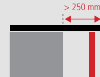
Abstützen freitragender Arbeitsplatten-Teile
